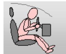
Na maior parte dos casos, a maior redução da velocidade do ocupante ocorre quando a cabeça ou o tórax atinge o volante (no caso de condutores) ou o painel de instrumentos e o pára-brisa. Cada parte do corpo do ocupante atinge as estruturas internas à sua frente em momentos minimamente diferentes, em um espaço de tempo praticamente idêntico ao que o veículo levou para desacelerar até parar completamente – ou seja, cerca de 1/10 de segundo.
